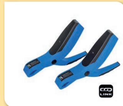
–Sonda de temperatura KANE-WCP2 Link: Inalámbrica, manda información de temperatura de la impulsión y retorno al analizador KANE458S Link. Son de gran ayuda en la puesta en marcha de calderas y comisionado de bombas de calor monobloque. Su rango de temperatura es 0-80°C.
