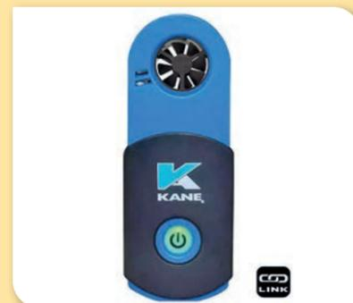
–Anemómetro KANE-DTHA2 Link: es un instrumento multifunción que permite medir con precisión la velocidad del aire, la temperatura y la humedad ambiental. Diseñado para integrarse con el analizador KANE458s Link, ofrece un rango de velocidad del aire de 1,1 a 20 m/s, un rango de temperatura de -20 °C a +50 °C y un rango de humedad relativa de 0,1 a 99 %, lo que lo convierte en una herramienta versátil y eficaz para aplicaciones en climatización, ventilación y control ambiental.
