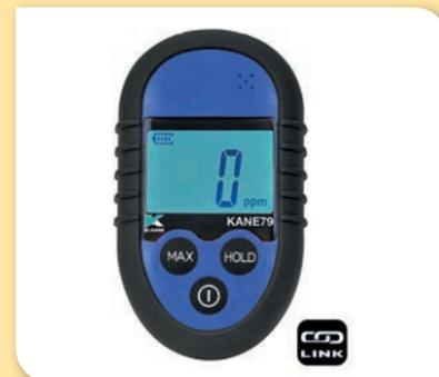
–Medidor de CO ambiente KANE79 Link: está diseñado para detectar y monitorizar concentraciones de monóxido de carbono en el entorno, enviando los datos directamente al analizador KANE458s Link. Ofrece un rango de medición de 0 a 999 ppm con una resolución de 1 ppm, lo que permite una lectura precisa y detallada. Además, admite la conexión simultánea de hasta cuatro detectores KANE79, facilitando el control en múltiples ubicaciones o zonas de una instalación.
