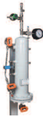
Figura 4. La cuarta edición de la norma API 682 recomienda configuraciones de cierre y venteo para todos los manómetros con el fin de facilitar la sustitución de los mismos sin necesidad de desmontar la bomba y el sistema auxiliar.
